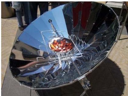
**Figura 2-13: Cocina solar parabólica.**
