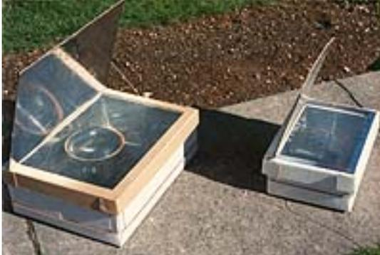
**Figura 2-14: Hornos solares tipo caja artesanales fabricados a partir de dos cajas de cartón y una lámina de vidrio.**
