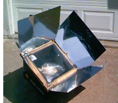
**Figura 2-15: Horno solar comercial de la marca Global Sun Oven.**
