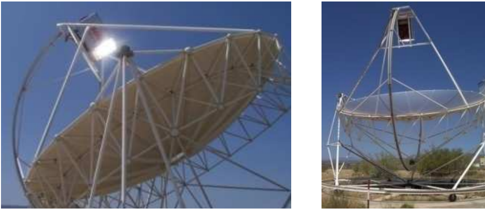
Figura 7: Sistema Disco-stirling de 10 kW desarrollado por la empresa alemana SBP.
